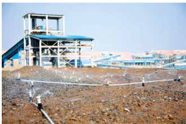
Muliashi項目堆浸系統1號堆場噴淋作業
